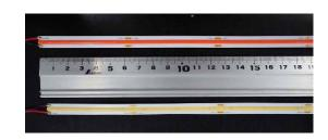
ドットにならないLEDテープライト 1 mあたり512個のLEDを搭載。 蛍光塗料樹脂のコーティングでドットレス 100 mmあたり1Wの高輝度設計です。
